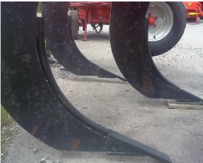
Figuur IIId. Twee verschillende beitelpunten. Links een nauwe en rechts een gevleugelde punt. Bron: CETAB, 2015.
