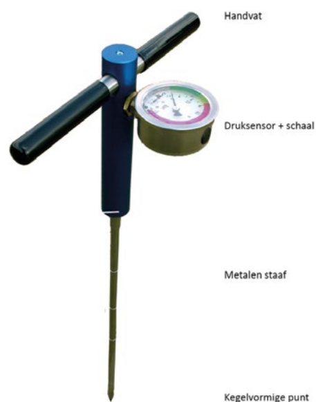
Fig 1d. Een penetrometer en haar onderdelen (merk Imants)
