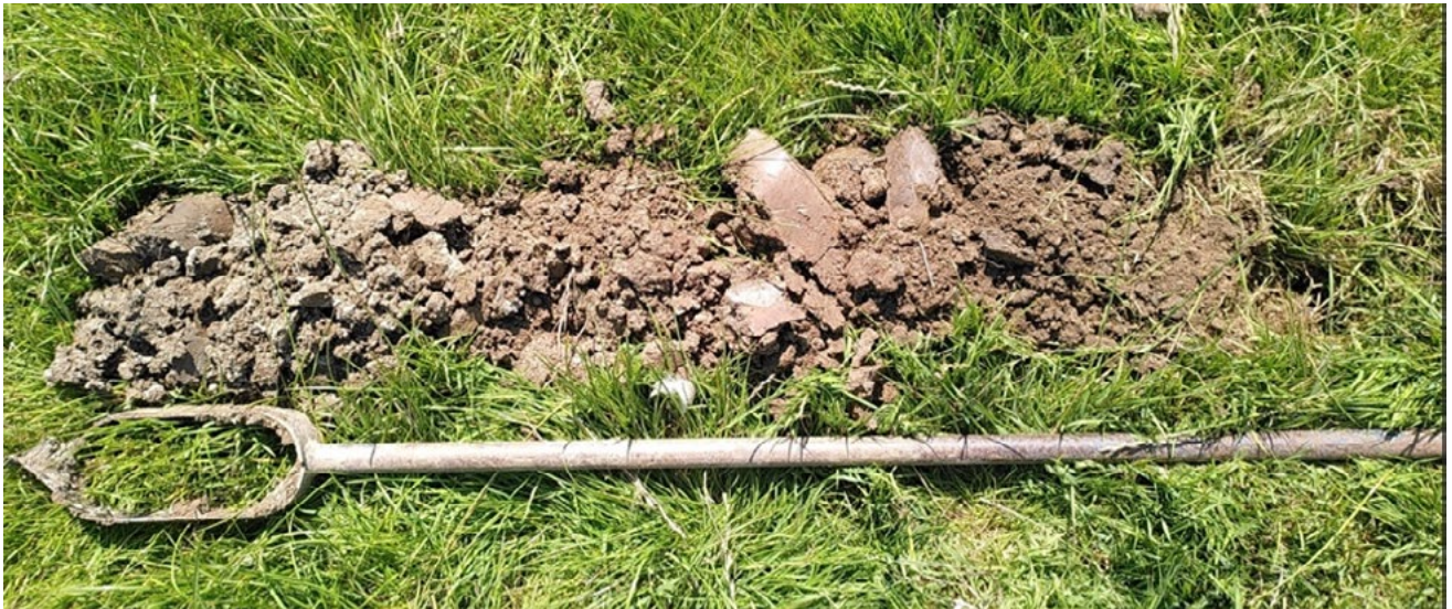
Figuur 2. Een bodemprofiel met de grondboor, van ca. 1m diep. Te lezen van rechts (oppervlak) naar links (ondergrond). Vanaf 25cm diep is de verdichte laag duidelijk zichtbaar door de grote gladde en dichtgepakte kluiten.
