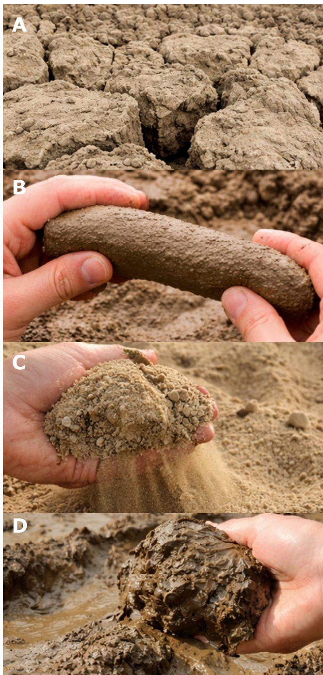
Figuur 4. A) Te droge kleigrond die keihard is en bros. B) Te vochtige kleigrond die nog kneedbaar is. C) Te droge zandgrond die poederig is en geen structuur behoudt. D) Te natte zandgrond die inzakt.
