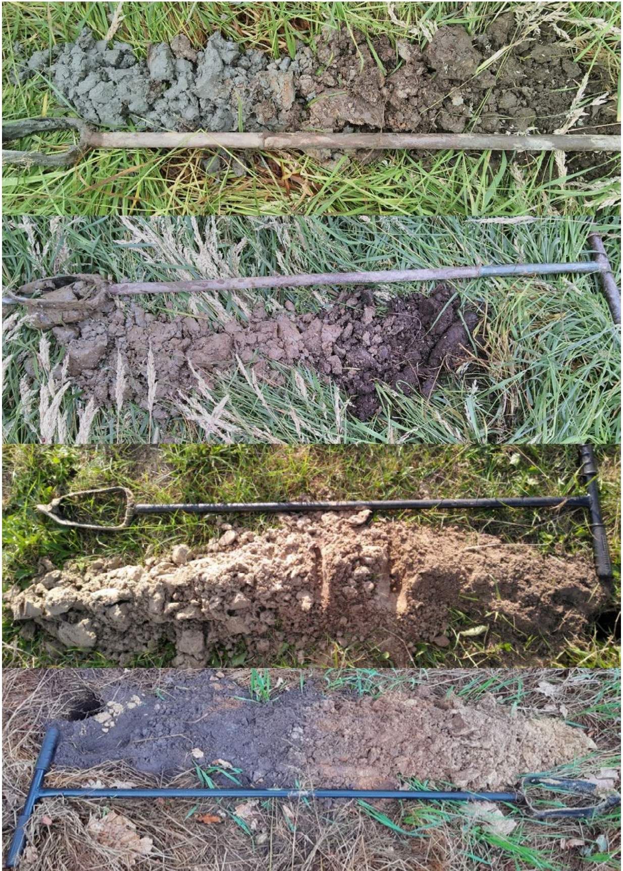
Figuur Ia. Vier bodemprofielen gemaakt op bodems die allen in meer of mindere mate verdicht zijn. Bij een uitgelegd profiel is dit zeker op zandgrond lastig zichtbaar, maar het is wel duidelijk voelbaar. Van boven naar onder; zeeklei nat, zeeklei wat droger, zand nat, zand droog.
