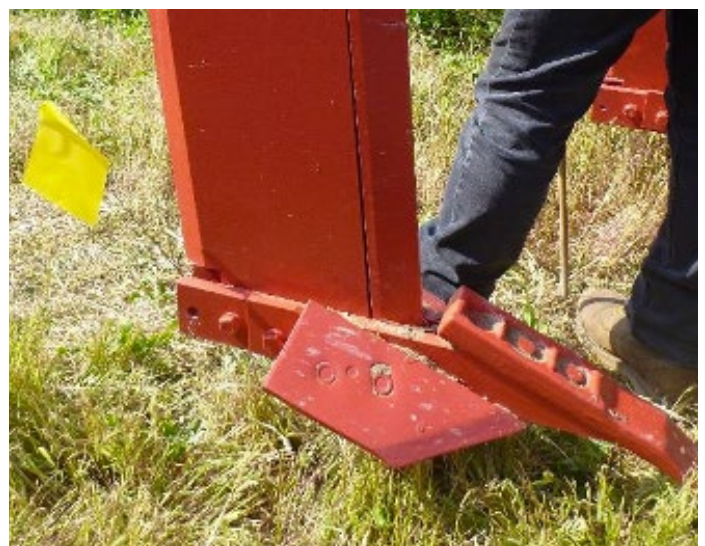
Figuur IIId. Twee verschillende beitelpunten. Links een nauwe en rechts een gevleugelde punt. Bron: CETAB, 2015.
