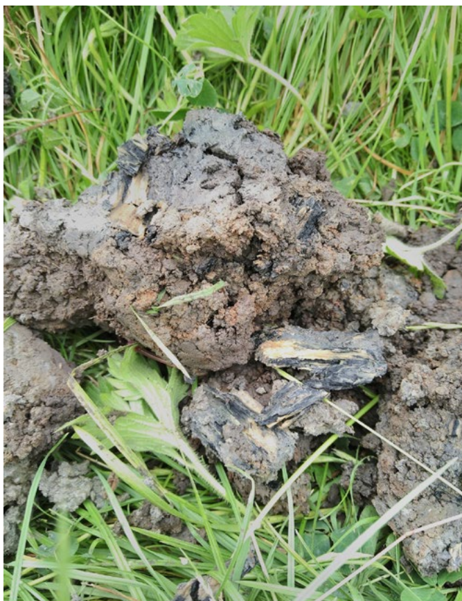
Fig 1b. Close-up met oranje roestplekken en onverteerd organisch materiaal zichtbaar, wat duidt op een gebrek aan zuurstof, bijvoorbeeld door staand water. Dit kan een indicatie kan zijn van verdichting in de ondergrond, maar het kan ook komen door een periodiek hoge grondwaterstand. Als je roest aantreft, boor dan dieper om de ondergrond te onderzoeken.
